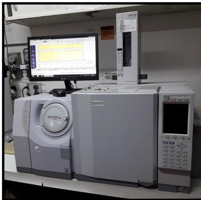
Figura 18. Equipo de cromatografía gaseosa asociada a un detector de masas, marca Shimadzu QP-2010-ULTRA
