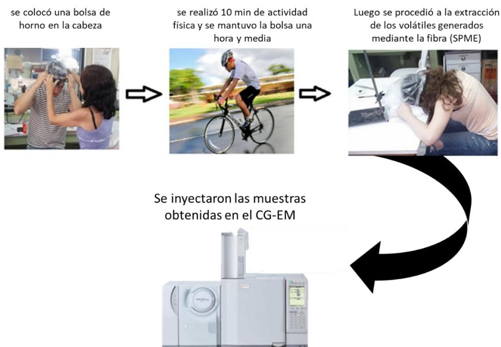
Figura 17. Esquema de obtención de los componentes volátiles del cuero cabelludo y posterior análisis mediante CG-EM.
