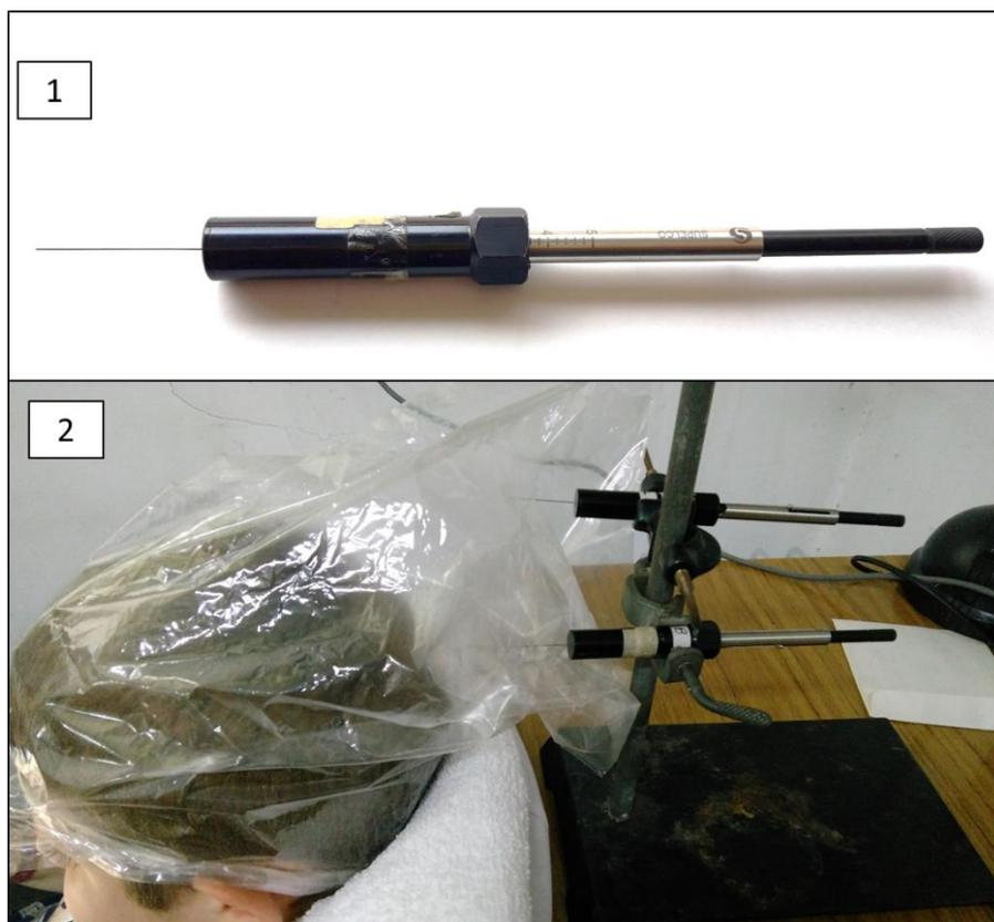
Figura 16. 1) Dispositivo SPME (DVB / CAR / PDMS, Supelco, Bellefonte, PA, USA) utilizado para coleccionar los volátiles generados por el cuero cabelludo. 2) metodología utilizada para la recolección de los compuestos volátiles.
