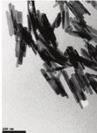
Fig. 5. Imagen obtenida por microscopía de transmisión electrónica (TEM) de NPs de goethita de 32 nm en longitud en el eje más largo (Mäkie y col. 2011).
