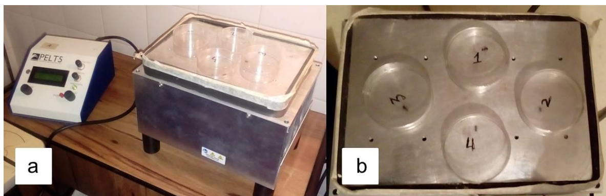
Figura 3.2: (a) Dispositivo para medir temperatura crítica mínima. Consta de una placa metálica con un controlador de la temperatura. (b) Vista superior de la placa metálica, donde se observan cuatro obreras de Acromyrmex spp. individualizadas en placas de Petri con vaselina en sus laterales para evitar el ascenso de las hormigas.
