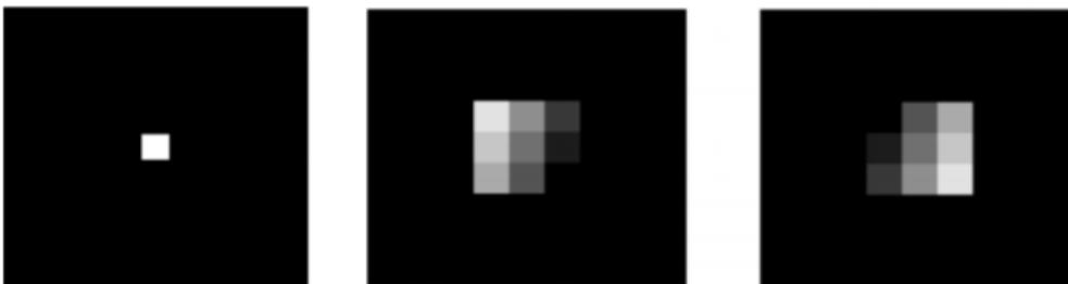
Figura 2.19: (Izquierda) Imagen original. (Centro) Resultado de una operación de correlación cruzada del kernel  $K$  con la imagen original. (Derecha) Resultado de una operación de convolución del kernel  $K$  con la imagen original.
