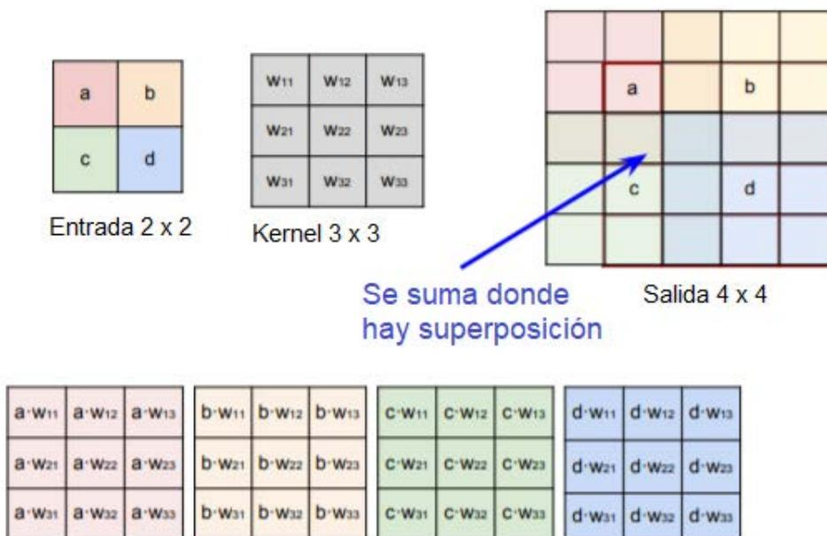
Figura 2.40: Ejemplo de una convolución transpuesta con una entrada de 2x2, un kernel de 3x3, un stride de 2 y un padding igual 1.
