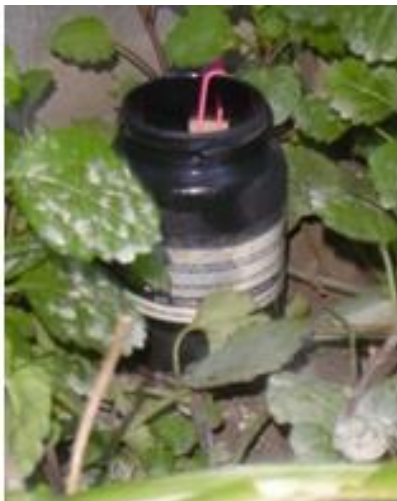
Figura 2. Ovitrapa; contiene un sustrato poroso con 1/3 del volumen con agua para que la hembra de Aedes aegypti pueda colocar sus huevos.
