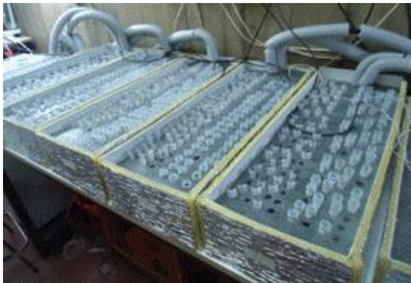
Figura 3. Baños térmicos utilizados para la cría de Aedes aegypti a diferentes temperaturas. Cada bandeja corresponde a una temperatura y dentro de cada bandeja se pueden observar tubos de cría individual (réplicas).
