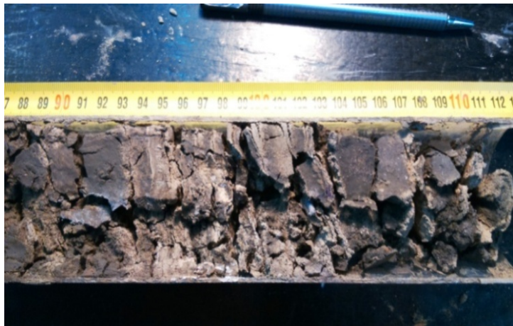
Figura 18: Intercalación de láminas de arena (claras) y arcilla (oscuras) en el sector basal del testigo
