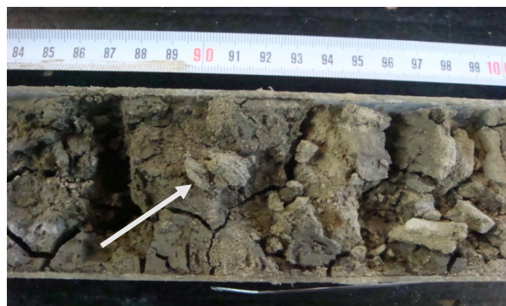
Figura 23: Banco arenoso correspondiente a la litofacies Sr. La flecha señala un trozo del material donde pueden observarse flasers
