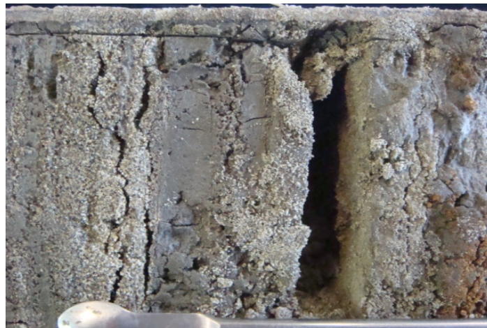
Figura 19: Intercalación de láminas de arena y arcilla en el tramo medio del testigo. La punta de la espátula marca laminación granodecreciente.
