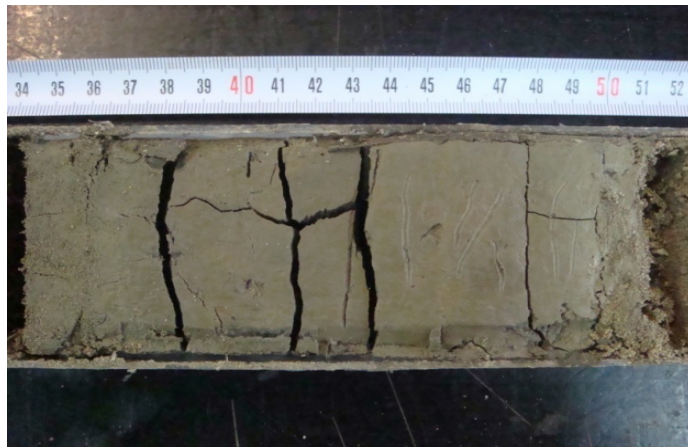
Figura 20: Litofacies Fsm, compuesta exclusivamente por material fino
