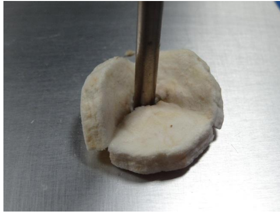
Figura 4.15. Análisis de textura, por el método de penetración sobre la muestra de TRE equilibradas en una humedad relativa del 22%.
