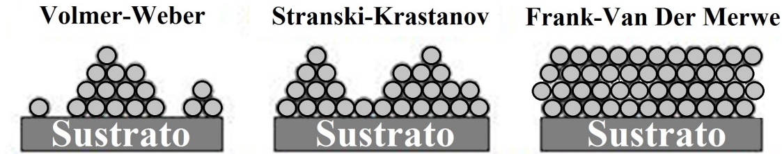
Figura 2.3: Representación esquemática de los distintos tipos de crecimiento de películas delgadas epitaxiales.
