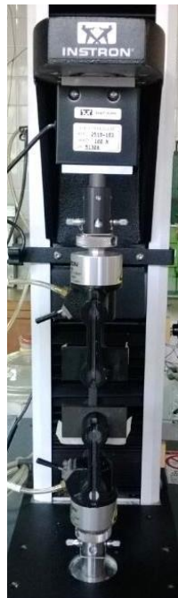
Figura 3.2. Ensayo de Tracción (muestra de película sostenida por mordazas neumáticas).
