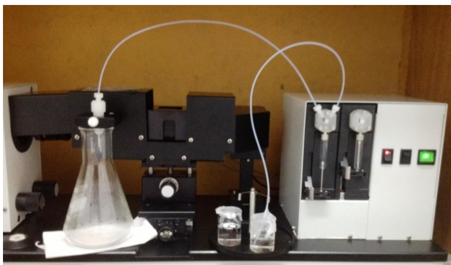
Figura 3.4. Tensiómetro usado para la medición del ángulo de gota.
