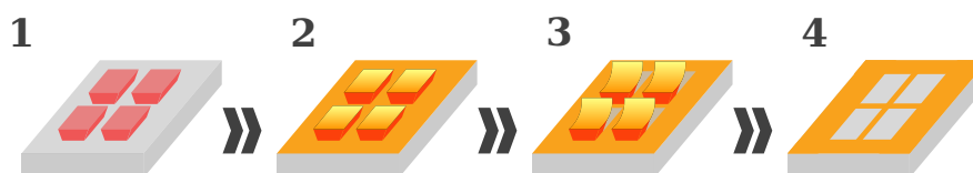
Figura 2.12: Esquema del proceso de lift-off en el cual se decapa la fotorresina. 1) Fotorresina transferida en base a un diseño, 2) depósito metálico, 3) disolución de la fotorresina con un solvente adecuado, 4) diseño completamente trasferido.
