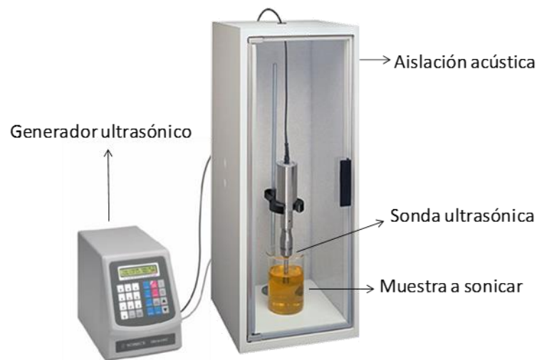
Figura 16. Equipo de ultrasonido de alta intensidad utilizado para la obtención de emulsiones O/W.
