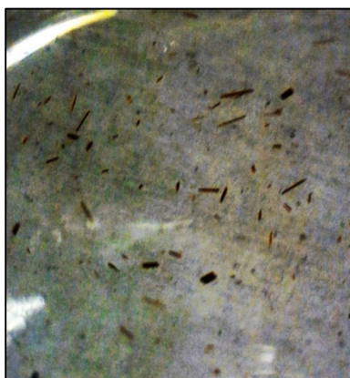
Figura 5.13. Fotografía de los cristales aciculares obtenidos, de unos pocos milímetros de longitud.
