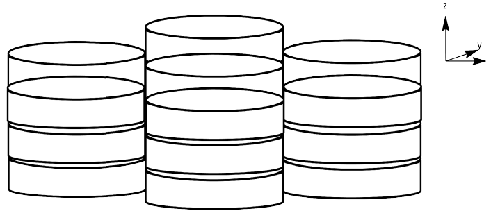
Figura 1.7. Esquema de la estructura de una fase Col h .
