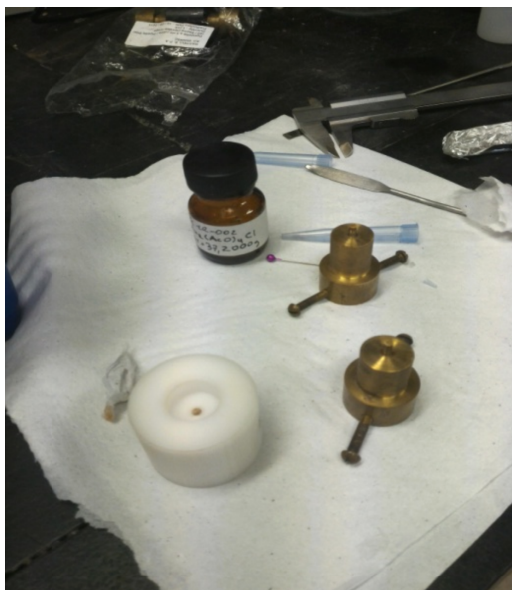
Figura 6.14. Dispositivo para medir conductividad (desarmado).
