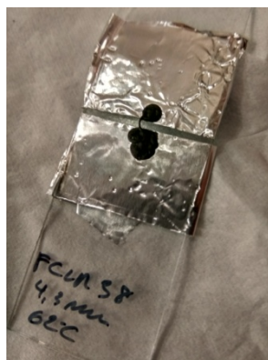
Figura 6.16. Fibra del complejo \text{Ru}_2(\text{B3OC14})_4 montada para ser medida.
