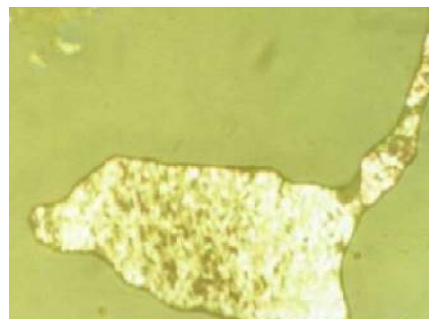
Figura 4.16. Fotografía MOLP a T_{amb} luego de calentar hasta paso isotrópico.
