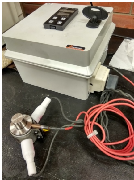
Figura 6.3. Fotografía de la microextrusora, camisa de temperatura y módulo de Control.
