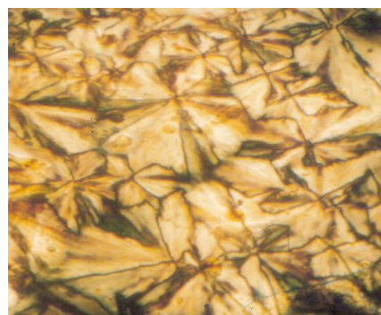
Figura 2.36 Fotografía MOLP a T_{amb} después de calentar hasta 90°C y enfriar lentamente.
