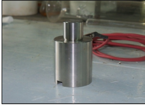
Figura 6.2. Foto de la microextrusora y termocupla.
