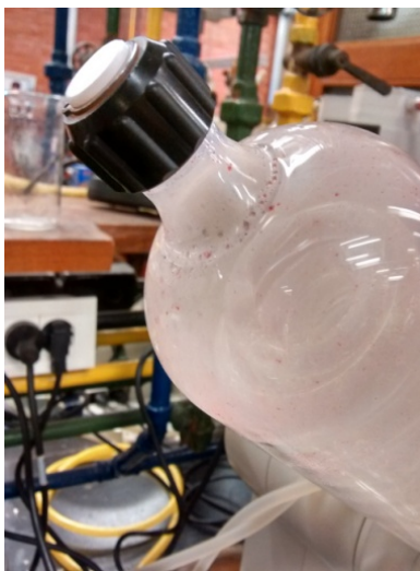
Figura 2.7. Tetrazina depositada en las paredes del refrigerante del Rotavap.
