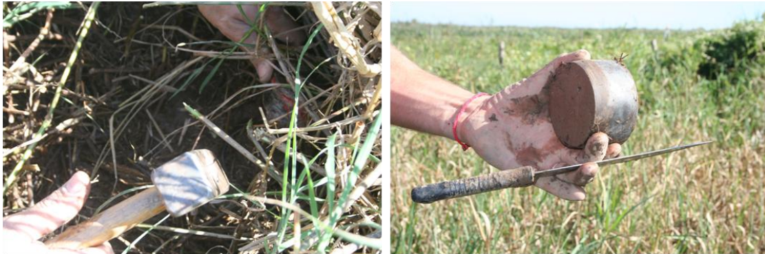
Foto 4.1: Muestreo de densidad aparente en el gradiente topográfico estudiado del Delta Medio del Río Paraná.
