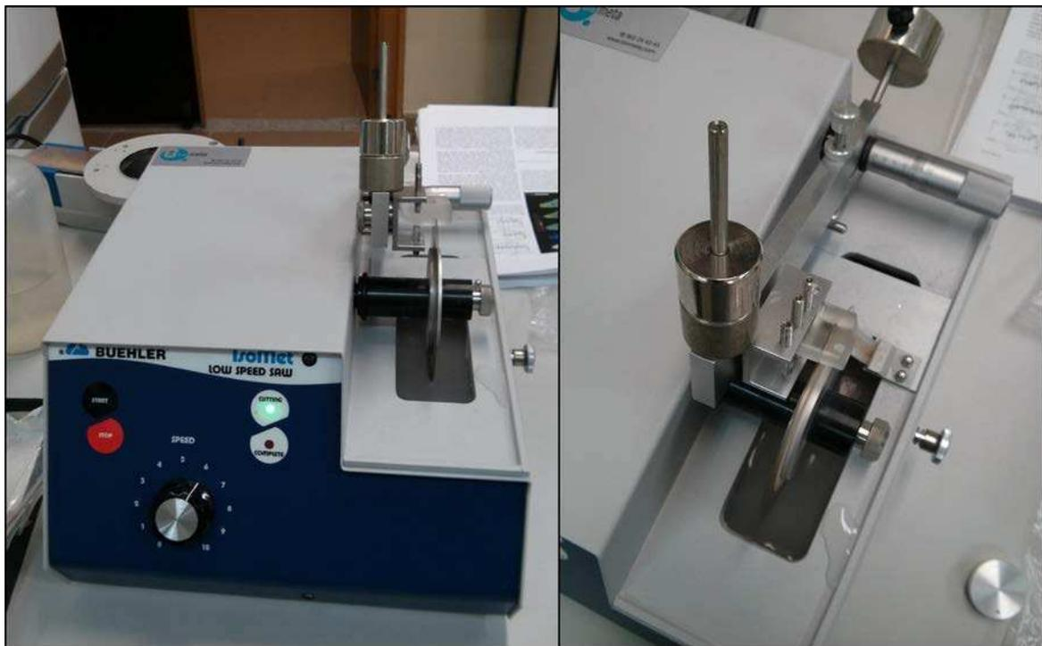
Fig. 6.3. Corte transversal del otolito *sagitta* efectuado mediante la utilización de una sierra Isomet ©Buehler.
