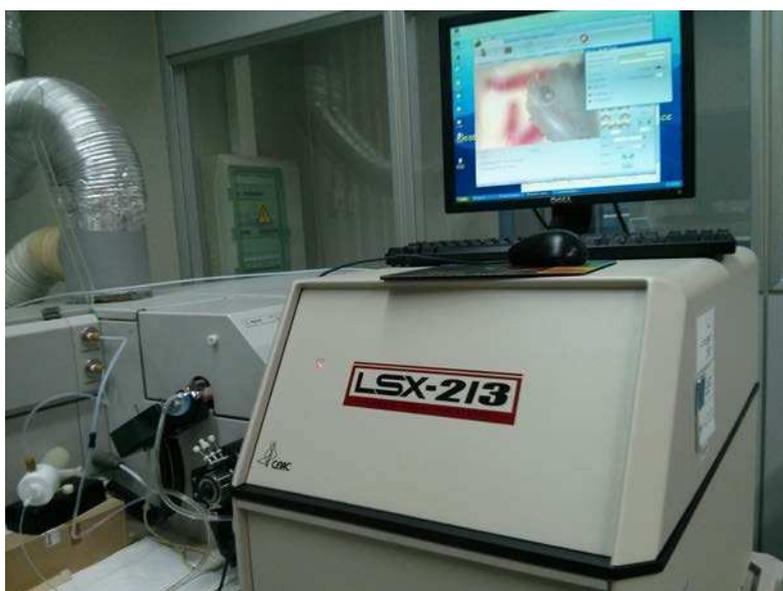
**Fig. 6.5.** Imagen del sistema de ablación láser CETAC LSX-213, acoplado al equipo Q-ICP-MS.
