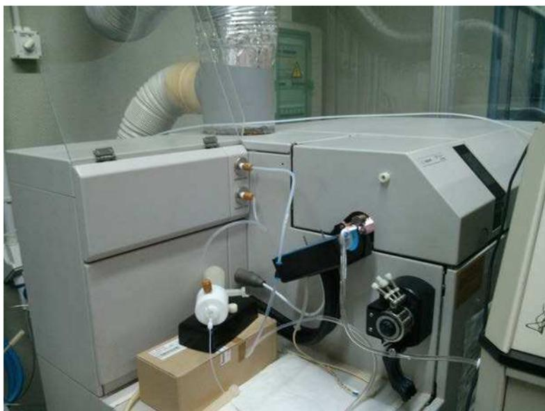
**Fig. 6.4.** Imagen del espectrómetro de masas con fuente de plasma de acoplamiento inductivo (Q-ICP-MS) Agilent 7500ce.
