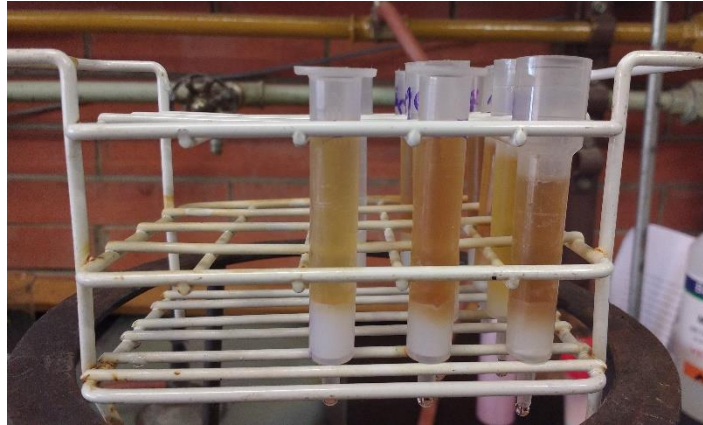
Figura 44. Muestras de la fracción soluble acuosa proveniente de los cultivos SSF pasando por las columnas C18.
