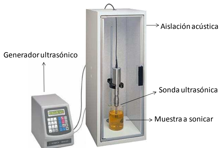
Figura 30. Equipo de ultrasonido de alta intensidad utilizado para la obtención de emulsiones O/W.
