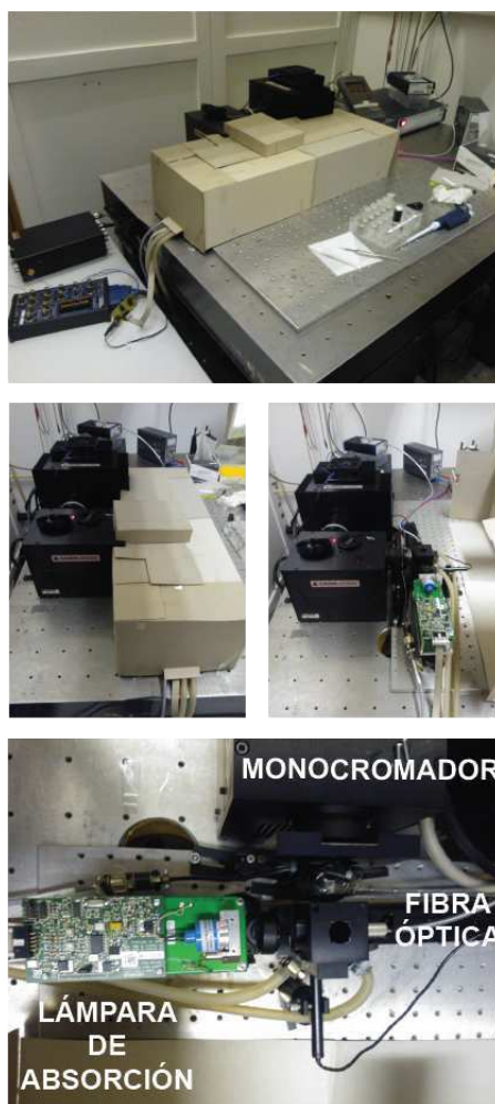
Figura 3.2: Fotografías del primer armado del espectrofotómetro y fotomodulador. Algunos componentes se señalan.
