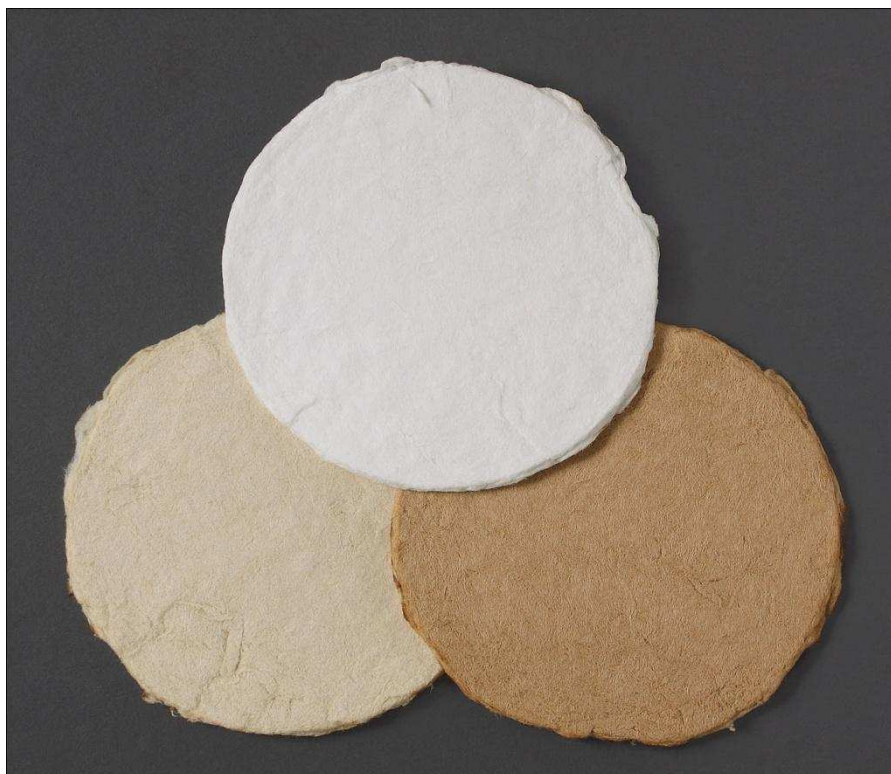
Fig. B. 14: abajo a la derecha pulpa Kraft lavada; abajo izquierda blanco pulpa Kraft lavada y blanqueada con H_2O_2 2%; superior pulpa Kraft lavada, incubada 1 h con sobrenadante de cultivo de C. antarcticus y blanqueada con H_2O_2 2,5%. T° 28°C.
