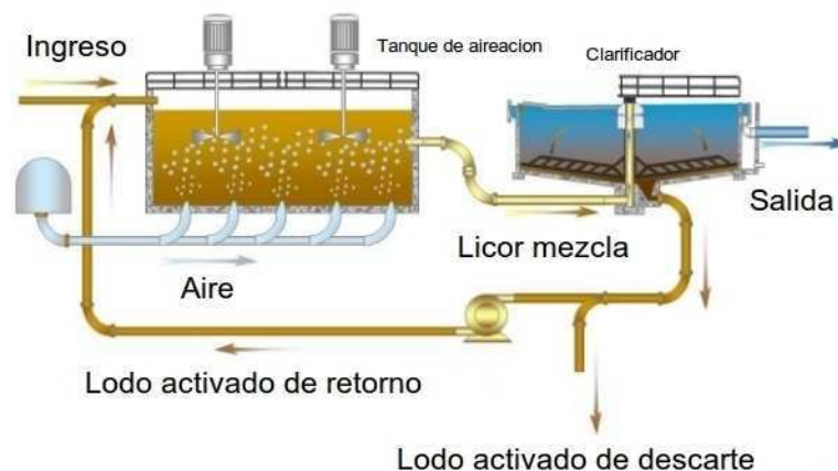
Figura 2: Esquema general del sistema de lodos activados convencional (Modificado de: www.ewisa.co.za )
