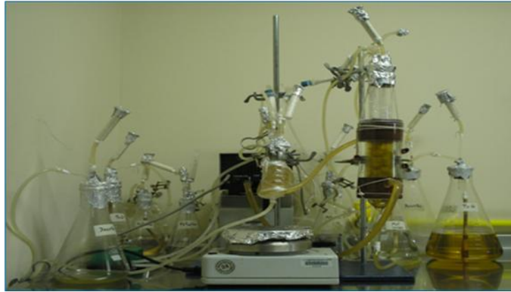
Fig. 4 Biorreactor de 50 mL y 200 mL con células inmovilizadas en esponjas de poliuretano.
