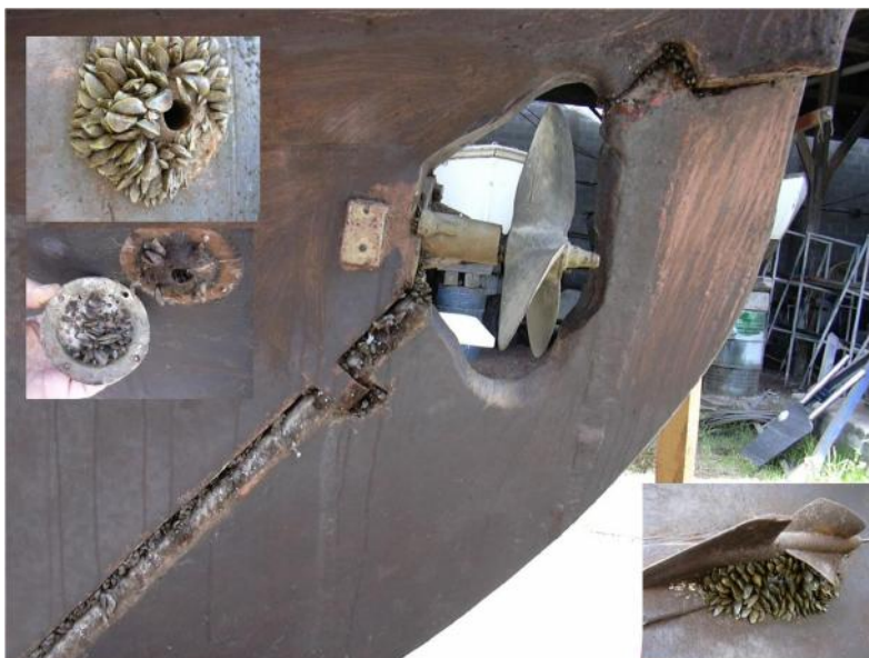
Figura 2. Colonización del mejillón dorado sobre distintas partes de las embarcaciones. Timón, corredera, toma de agua del sistema de refrigeración del motor.
