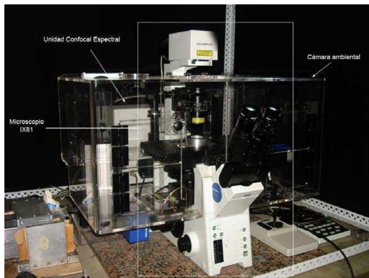
Figura 3.10. Microscopio confocal espectral Olympus FluoView 1000. Fotografía del microscopio confocal empleado, indicando la unidad confocal espectral, el microscopio base IX71, y la cámara ambiental.
