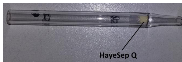
Figura 2.5. Trampa de volátiles con el adsorbente HayeSep Q.
