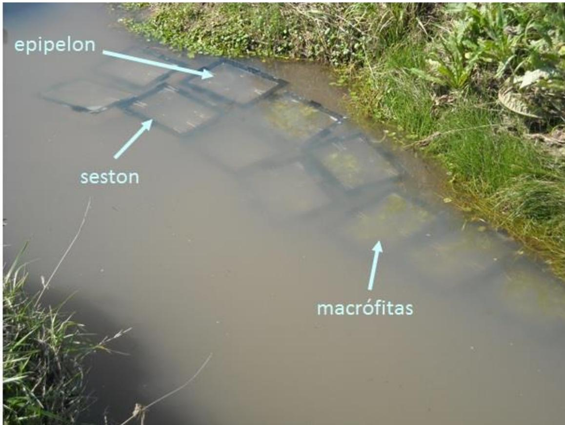
**Figura 3.8.** Vista de las cámaras de metabolismo con algunos de los compartimentos utilizados, sumergidas en el arroyo para la incubación.
