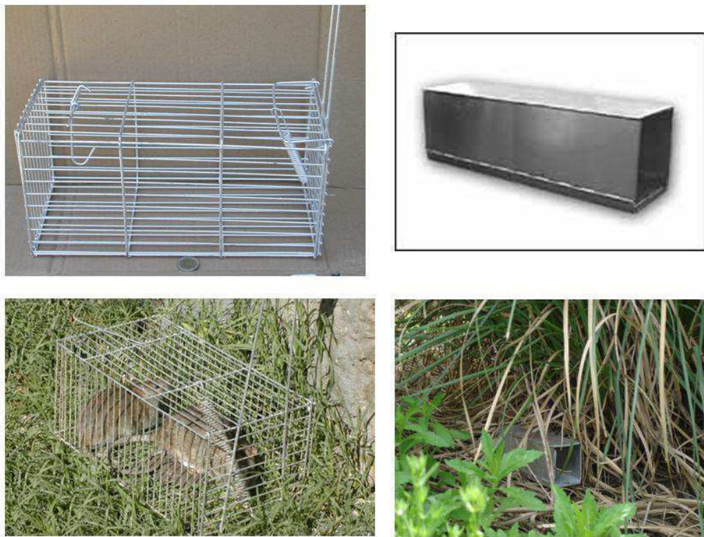
Figura 2.6: Fotografías de ambos tipos de trampas utilizadas (trampas tipo jaula y tipo Sherman) para la captura de roedores.
