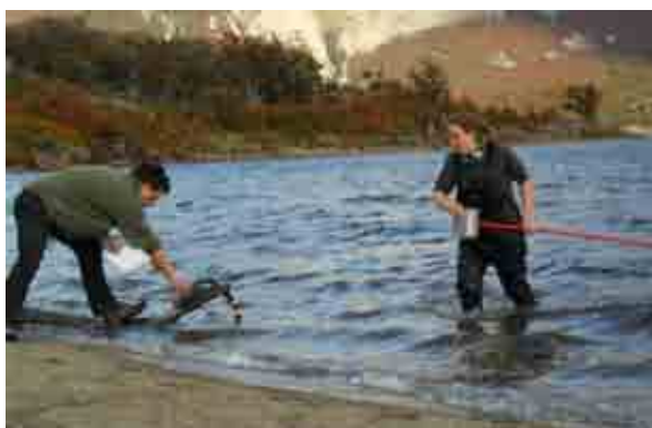
Figura 11. Medición in situ de parámetros físico-químicos y muestreo de sedimentos superficiales. Laguna Capri, Santa Cruz, Abril de 2013.
