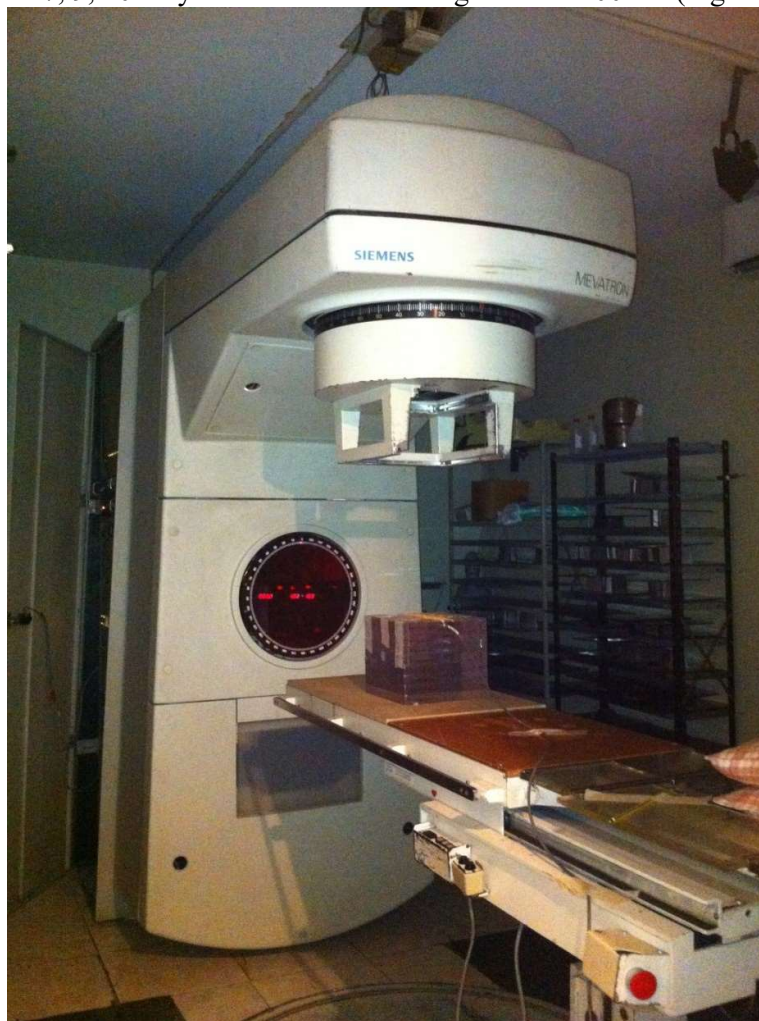
Figura 27. Acelerador lineal dual, Siemens Mevatron, radio de giro 100 cm
