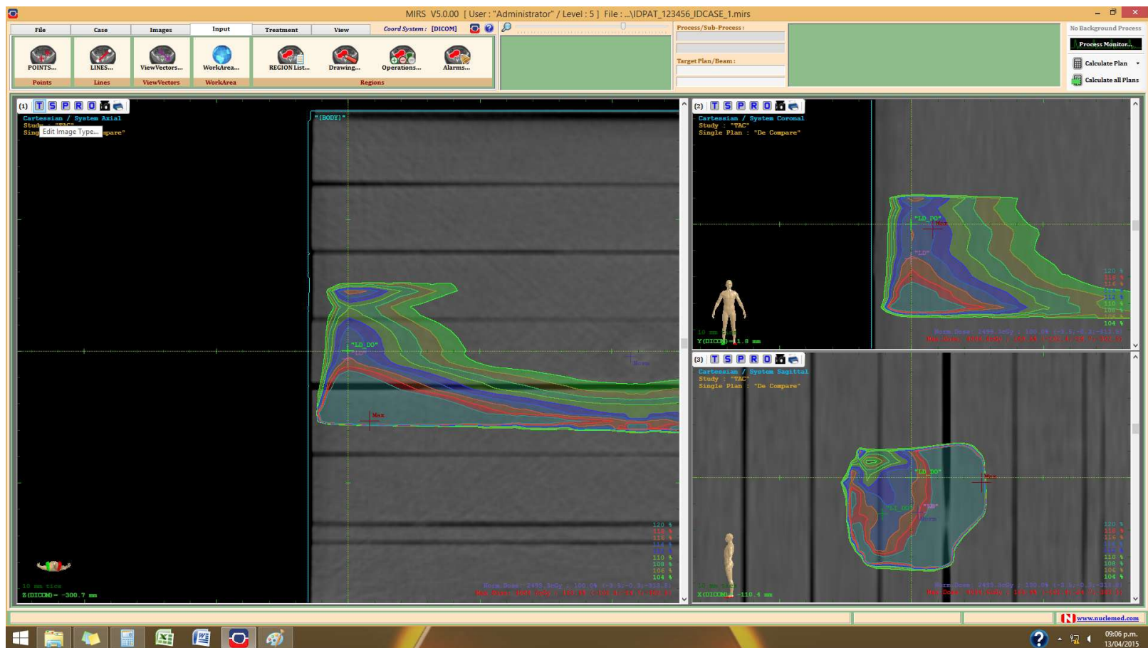
Figura 43. Curvas de isodosis sobre el fantoma, en configuración de dos campos opuestos, a la entrada del campo Lateral Derecho. En rosado, LD es el punto de dosis para el eje central; en verde, LD_DO es el punto de mínimo gradiente determinado, con aporte del campo opuesto. Se puede observar que hay una mayor densidad de líneas cerca al eje central y que en general, la zona desplazada presenta un menor gradiente. A la izquierda se observa el corte axial; a la derecha y superior el corte coronal; a la izquierda e inferior, el corte sagital.
