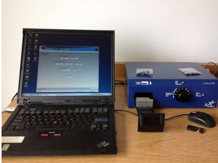
Figura 25. Sistema de lectura de dosímetros, a la derecha está el lector microStar, a la izquierda, el computador que incluye el software.
