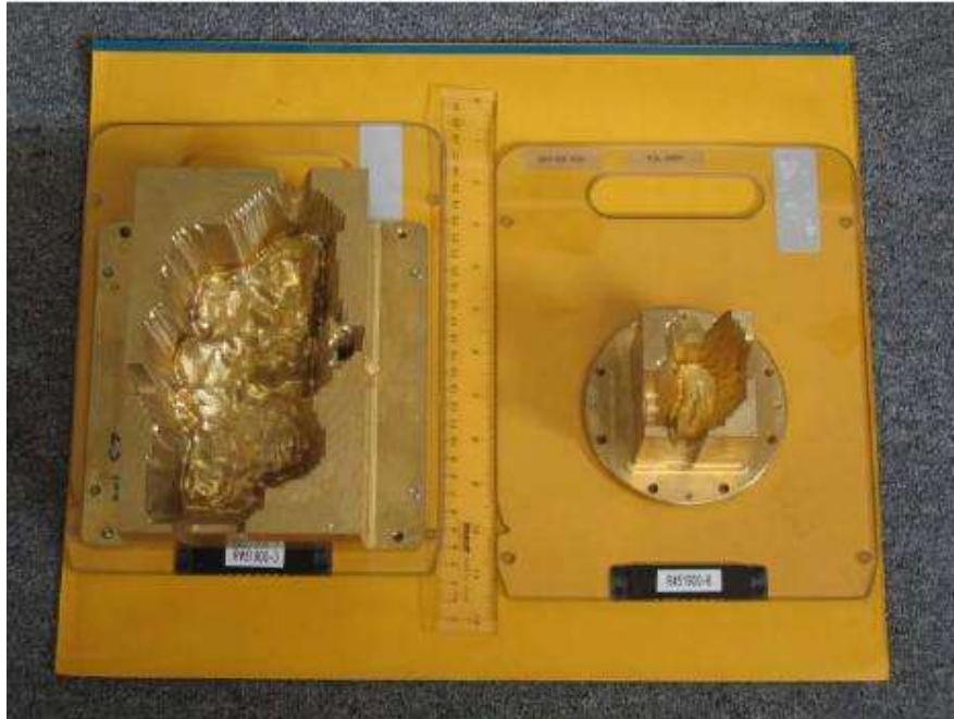
Figura 6. En la figura se muestran dos filtros compensadores, a la izquierda un filtro para un tratamiento de cáncer de pulmón (11.3 Kg), a la derecha un filtro compensador para tratamiento de cáncer de próstata.
