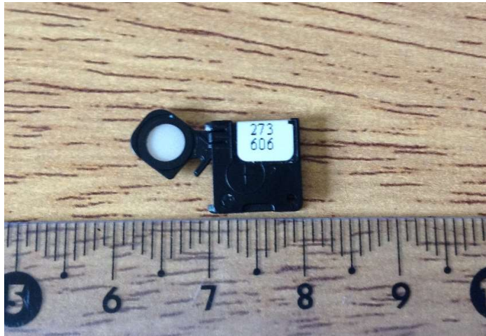
Figura 23. Dosímetro nanoDot OS, se muestra el volumen sensible.
