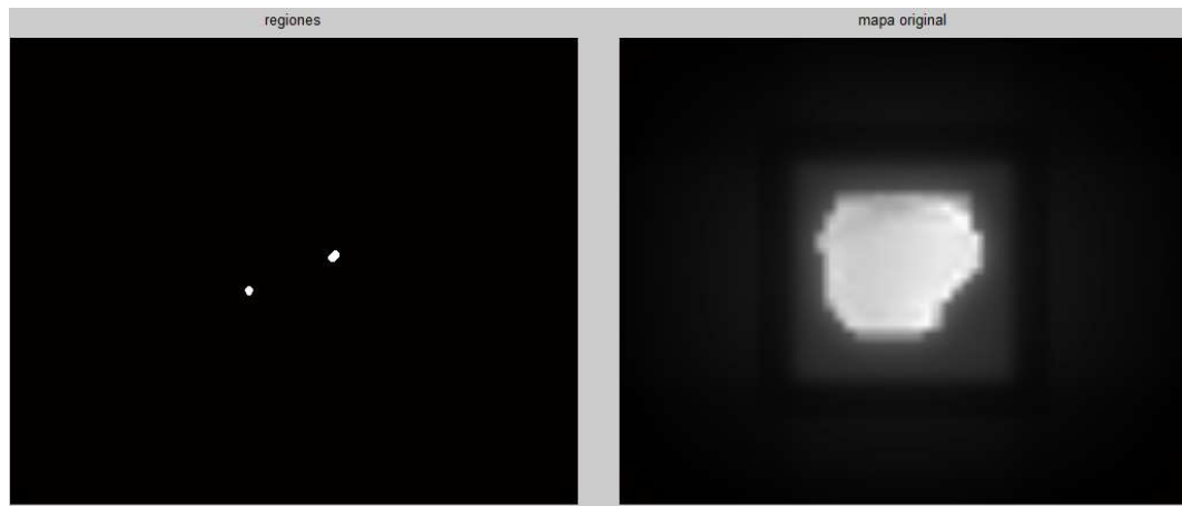
Figura 34. Imagen procesada para la determinación de zonas de bajo gradiente, a la izquierda, se muestran únicamente los valores de los píxeles, en los que las diferencias cuadráticas medias son menores que cierto umbral. Se puede observar que en este caso, se determinaron dos regiones dentro del campo de tratamiento. A la derecha se muestra el mapa de fluencias original.
