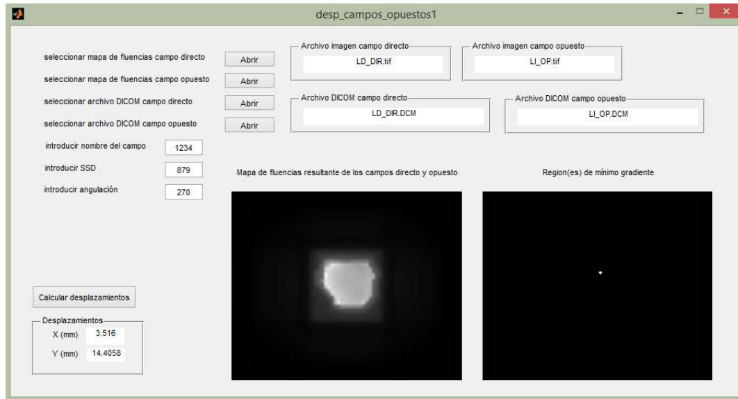
Figura 42. Programa desarrollado en Matlab para determinar las zonas de mínimo gradiente, a partir de los mapas de intensidades exportados y los archivos DICOM RT. En la figura a la izquierda se muestra el mapa de intensidades para el campo LD, a la profundidad de z_{max}=1,5 cm, que incluye el aporte del campo opuesto. A la derecha, se observa la zona determinada con el procedimiento descrito en el capítulo 4.4. Los desplazamientos calculados corresponden a la posición de la región hallada en la figura de la derecha, en milímetros, a ubicar sobre el paciente.
