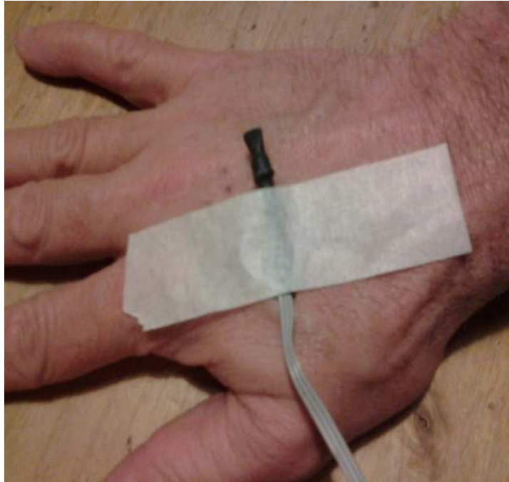
Imagen 12. Se observa uno de los sensores MOSFET del prototipo de sistema dosimétrico que se utilizó para realizar las mediciones y análisis en esta tesis.
