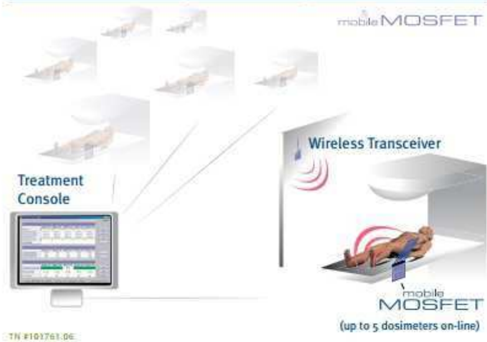
Imagen 6. Dispositivos MOSFET de dosimetría in vivo con tecnología inalámbrica para transmisión de datos.
