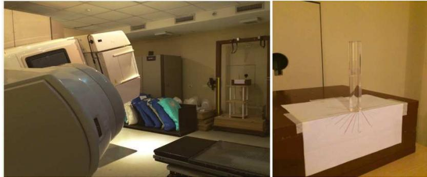
Figura 4.15. Geometría de Irradiación de los dosímetros OSLD en condiciones de TSEI para evaluar la dependencia angular utilizando un fantoma cilíndrico de acrílico.
