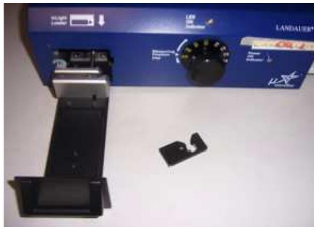
Figura 4.4. Lector microStar con la gaveta extendida mostrando la zona de inserción de los OSLD.
