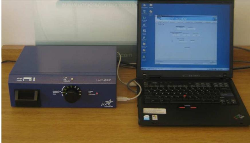
Figura 4.3. Lector microStar acompañado con la portátil que contiene el software respectivo.
