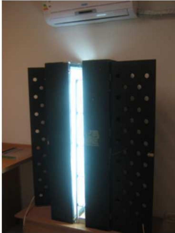
Figura 4.6. Sistema de blanqueo óptico de los OSLD
