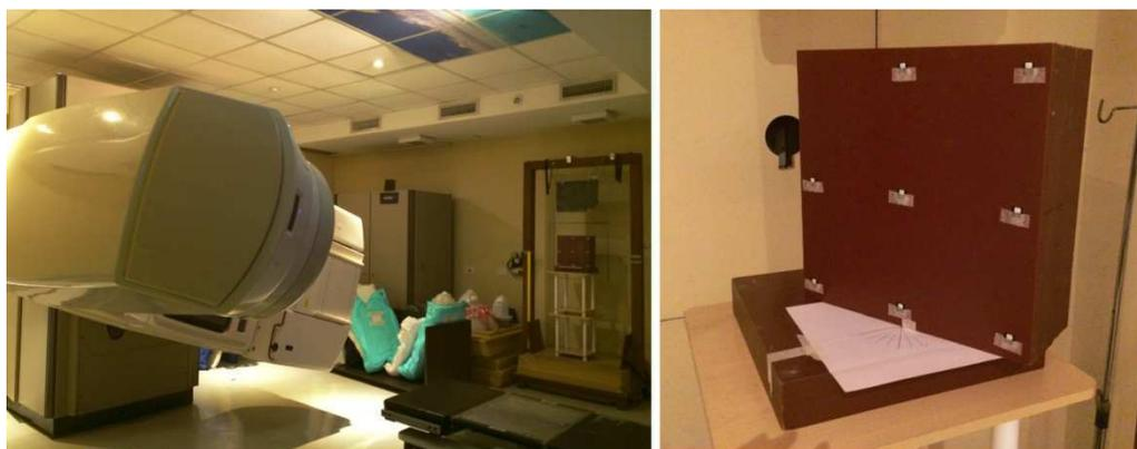
Figura 4.17. Geometría de Irradiación de los dosímetros para la verificación en fantoma de la técnica de dosimetría in vivo.
