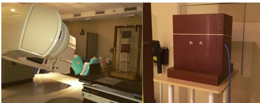
Figura 4.12. Geometría de Irradiación de los dosímetros OSLDs en condiciones de TSEI para obtener los respectivos factores de calibración.
