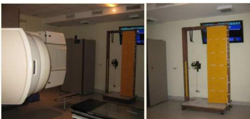
Figura 4.8. Ubicación placas KODAK X-OMAT V para determinar el perfil del campo.
