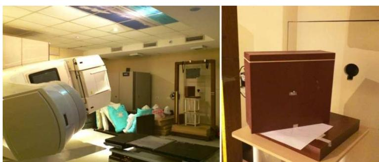
Figura 4.14. Geometría de Irradiación de los dosímetros OSLDs en condiciones de TSEI para evaluar la dependencia angular.
