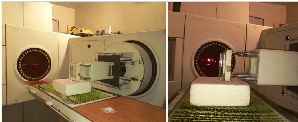
Figura 4.16. Geometría de Irradiación de los dosímetros OSLD a  $\text{DFP} = 100 \text{ cm}$  para evaluar la dependencia angular utilizando un fantoma cilíndrico de acrílico.
