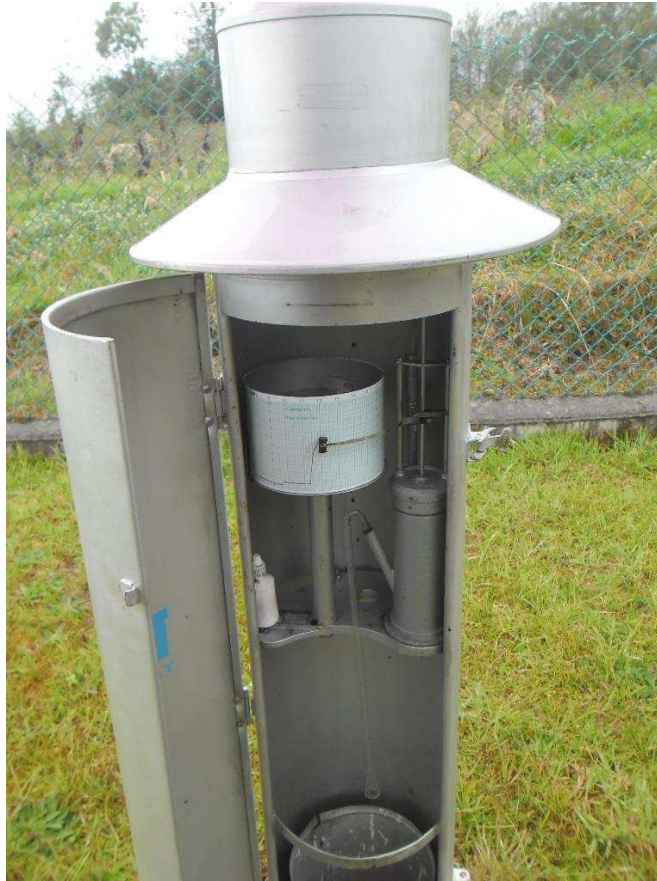
Figura 2.2 Fotografía pluviógrafo empleado en el área de estudio. Fte L. Narvaez
