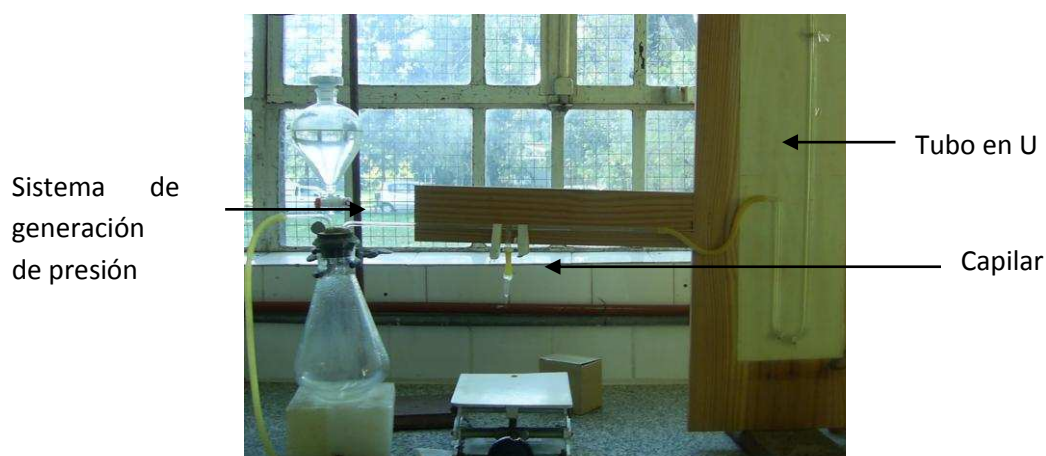
Figura 2-73. Instrumento utilizado para la medición de tensión superficial.
