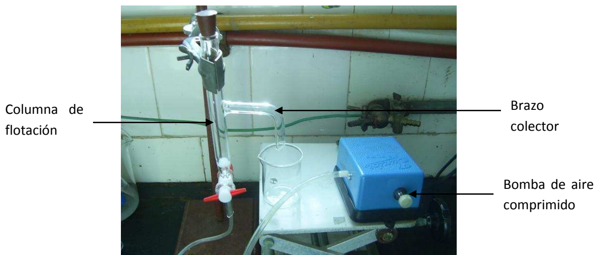
Figura 2-74. Equipo de flotación.
