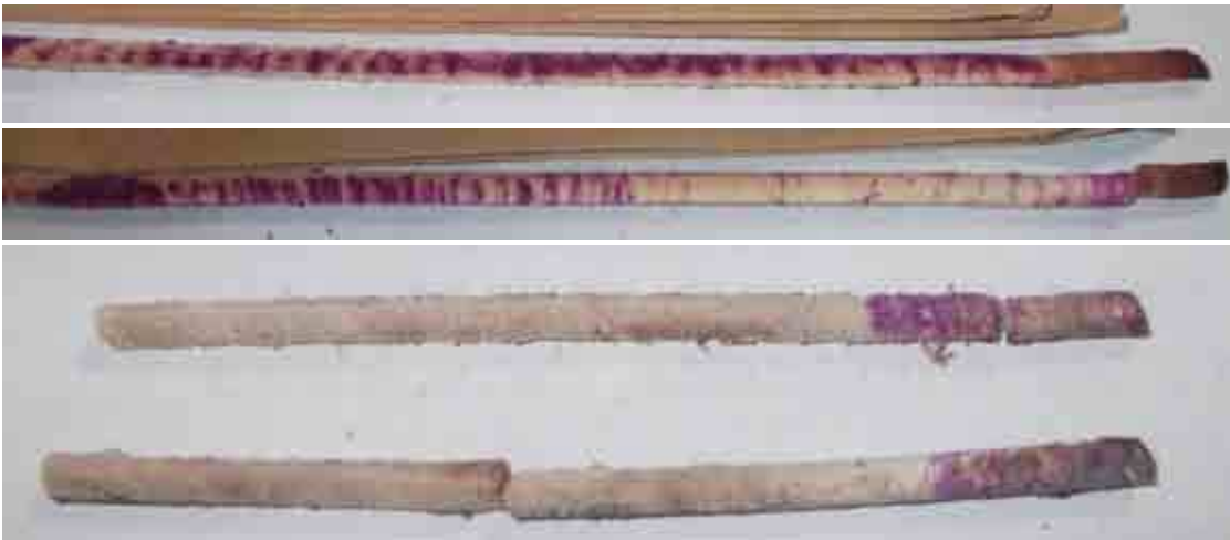
Fotografía 10. Muestras obtenidas luego de la tinción con safranina. Arriba, Araucaria angustifolia , especie de Gimnosperma y abajo, Eucalyptus grandis , especie de Angiosperma de madera oscura.
