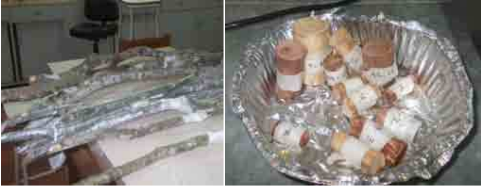
Fotografía 5. Material utilizado en a) ensayos de flexión estática de carga puntual con 2 puntos de apoyo y b) mediciones de densidad de madera.
