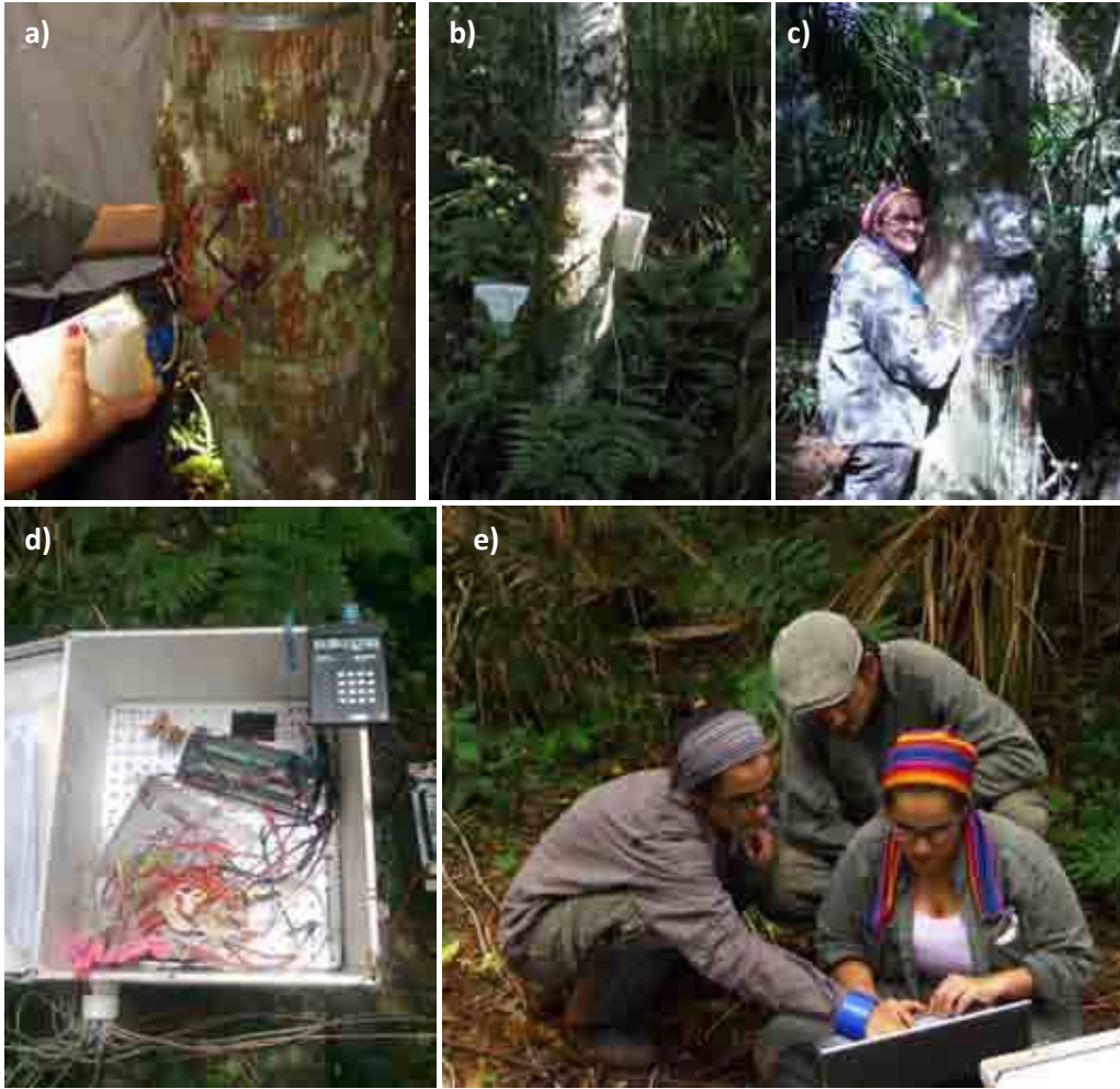
Fotografía 9. Mediciones de flujo de agua mediante método de disipación de calor constante; a, b y c) los sensores y sus coberturas para evitar la exposición al sol y d) datalogger, multiplexer; e) Monitoreo el funcionamiento de los sensores y bajada de datos.
