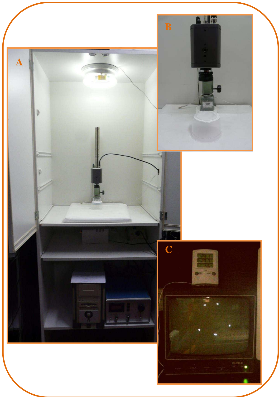
Figura 2.3. Bioensayos de actometría. A) La arena experimental estuvo ubicada dentro de un mueble de madera cuya puerta se cerraba durante los bioensayos; en el estante inferior se encuentra el actómetro y la computadora personal). B) La cámara de video y la arena experimental. C) Monitor del actómetro (sobre él, termómetro digital para monitorear la temperatura dentro y fuera del mueble).
