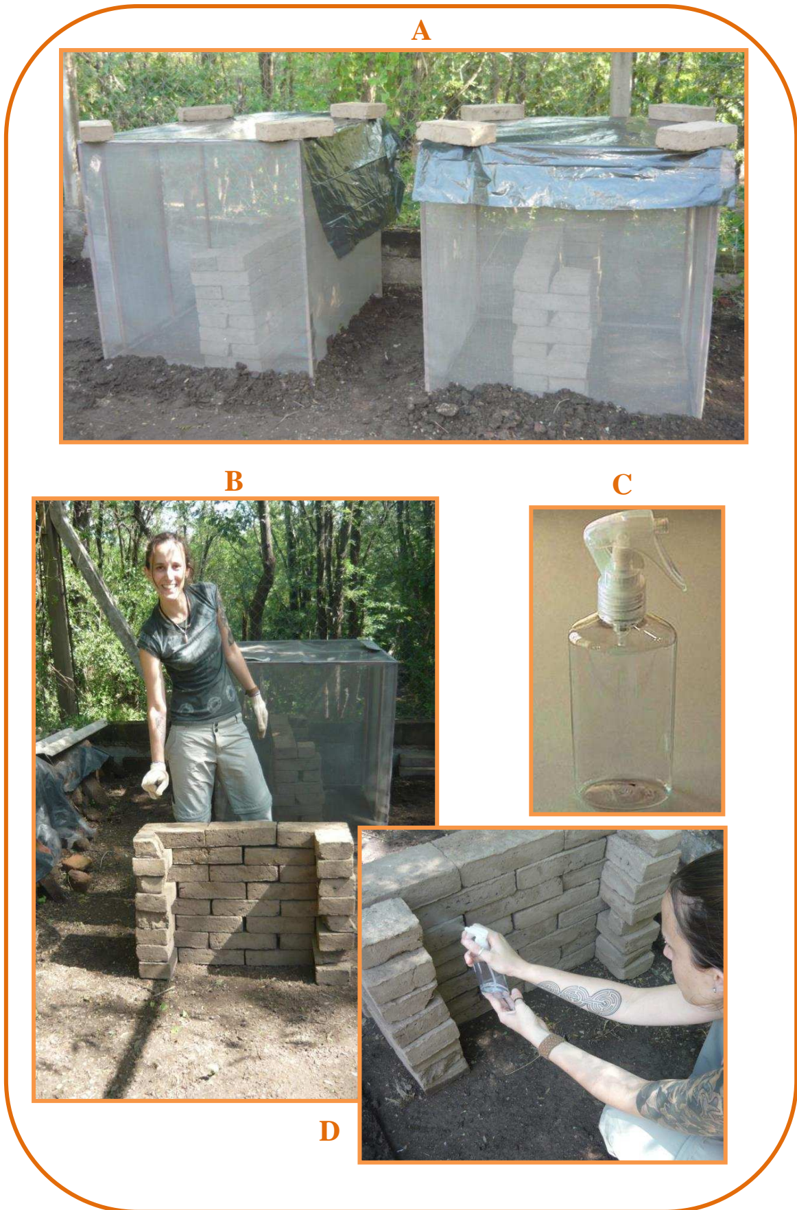
Figura 2.6. A) Paredes experimentales con jaula de protección; B) pared experimental al descubierto; C) rociador plástico; D) detalle de la aplicación del tratamiento.
