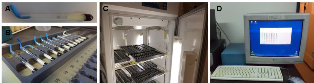
Figura 18. Registro automatizado de la actividad locomotora. A , Se muestra una mosca colocada en el tubo que contiene alimento en un extremo. B , Se muestra un monitor de actividad con conteniendo los tubos individuales, cada uno con una mosca en su interior. En cada posición del monitor la actividad es registrada con un emisor y un detector de luz infrarroja; el desplazamiento de las moscas dentro del tubo interrumpe el haz de luz y cada interrupción es contabilizada como un evento. C-D , Los monitores se colocan dentro de la incubadora y conectan al sistema de detección los cuales se registran en la computadora.
