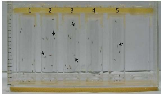
Figura 16: Dispositivo RING. El aparato permite colocar 6 viales de vidrio (aquí se muestran solo 5), los cuales contienen a las moscas. El dispositivo es golpeado suavemente para asegurar que las moscas estén abajo al comenzar la prueba y se las deja escalar por un tiempo dado, al cual se toma una fotografía. Las flechas indican las moscas dentro de cada vial.
