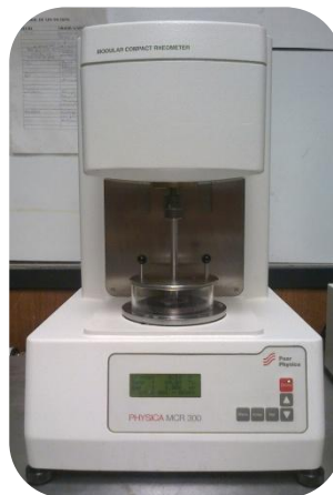
Figura 3.10. Reómetro oscilatorio dinámico Phaar Physica MCR 300 y aro con tapas.
