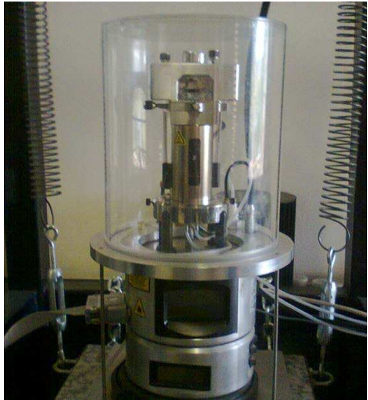
Figura 3.10: Cámara ambiental (CA), montada en el AFM. Los tubos de cobre de entrada y salida de gases no se observan por estar en la parte trasera (tapados por el AFM).
