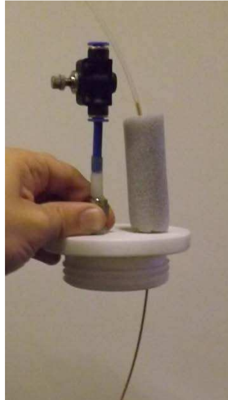
Figura 3.14: Tapa hermética del termo de nitrógeno líquido, mecanizada en teflon. Se aprecian la tubería pasante de PEEK y la válvula aguja usada para regular la presión del termo.
