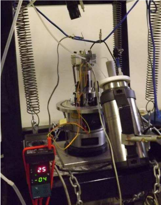
Figura 3.13: Vista del Microscopio de Fuerza Atómica (AFM) y de los accesorios de control de temperatura y humedad.
