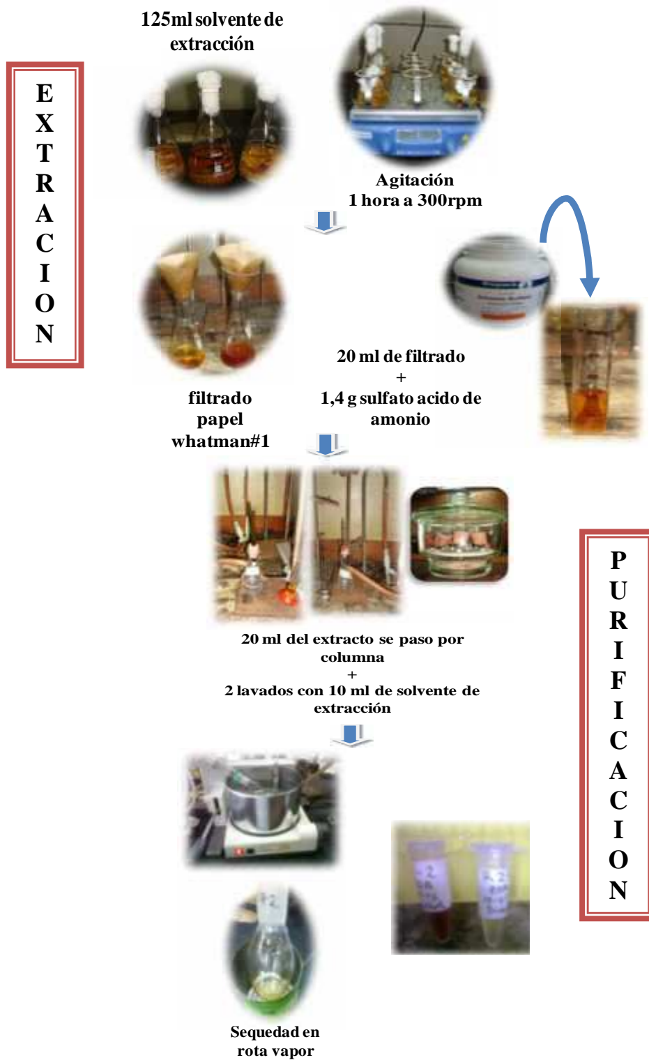
Figura 21. Extracción y Purificación de Tricotecenos (según Trucksess et al., 1984).
