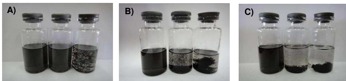
Figura II.20. Fotografías de las dispersiones de NTCs en tolueno: NTC-PS/DT (izquierda); NTC-PS sin DT (medio); NTCs purificados/DT (derecha). Las imágenes a,b y c corresponden a las fotografías de cada dispersión tomadas luego de 2, 10, y 40 min después de su preparación, respectivamente.
