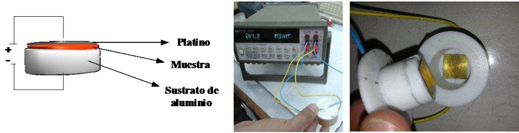
Figura V.3. Esquema del circuito empleado para determinar la conductividad volumétrica (izquierda) e imagen del dispositivo empleado para las determinaciones de conductividad en el modo de cuatro puntas (centro y derecha).
