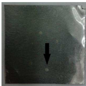
Figura V.6. Imagen de la muestra epoxi curada. La flecha indica la hendidura realizada durante el ensayo de desgaste.
