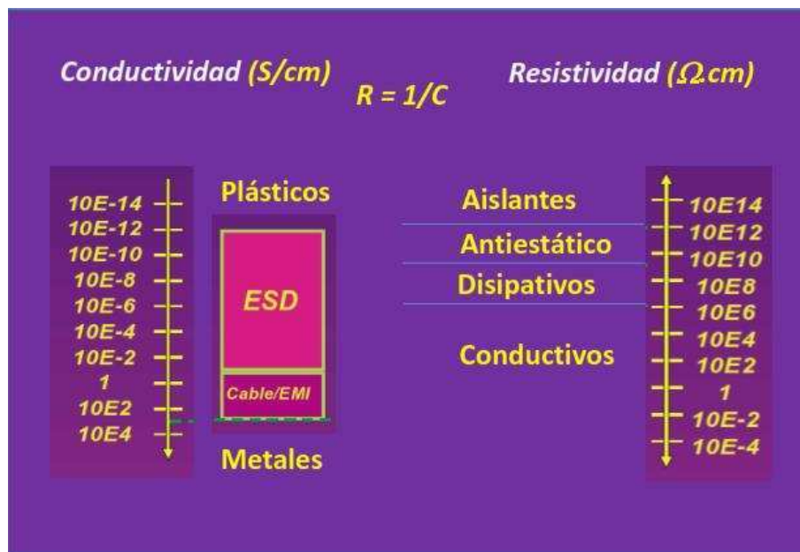
Figura V.2. Rango de conductividad y resistividad para materiales con aplicaciones eléctricas. ( surface and volume resistivity test for EDS and power cable semiconductive compounds. Cabot ).
