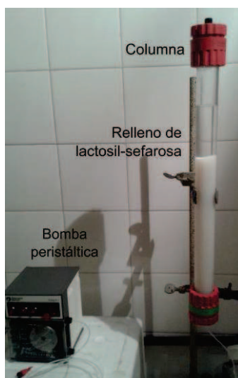
Figura II.4. Columna de afinidad , rellena con lactosil-sefarosa. Al costado de la columna, se muestra la bomba peristáltica utilizada para hacer circular los diferentes buffers a través de la misma.
