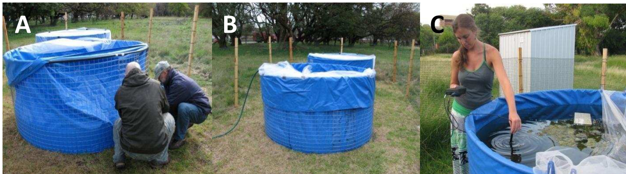
Figuras 21 A, B y C: (A) instalación de los tanques en el Campo Experimental; (B) llenado con agua de red; y (C) monitoreo de variables fisicoquímicas con sensor multiparamétrico de campo.
