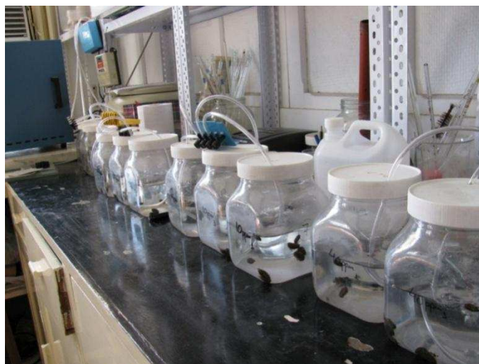
Figura 15: ensayo de toxicidad en acuarios de 2 litros con 10 individuos de Limnoperna fortunei cada uno expuestos a distintas concentraciones de glifosato (0, 10, 20 y 40 mg l -1 ) por triplicado.
