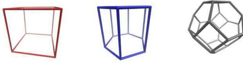
FIGURA 8.14: Celdas cúbica, prisma hexagonal y octaedro truncado.
