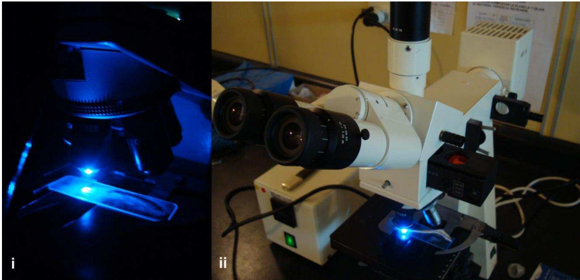
Figura 5.3.3. Análisis de marcas de calceína en valvas de O. puelchana con microscopio epifluorescente. i. Haz de luz azul sobre corte delgado de valva de O. puelchana . ii. Observación de los cortes delgados en oscuridad con instrumental óptico de la UNPSJB del CENPAT.
