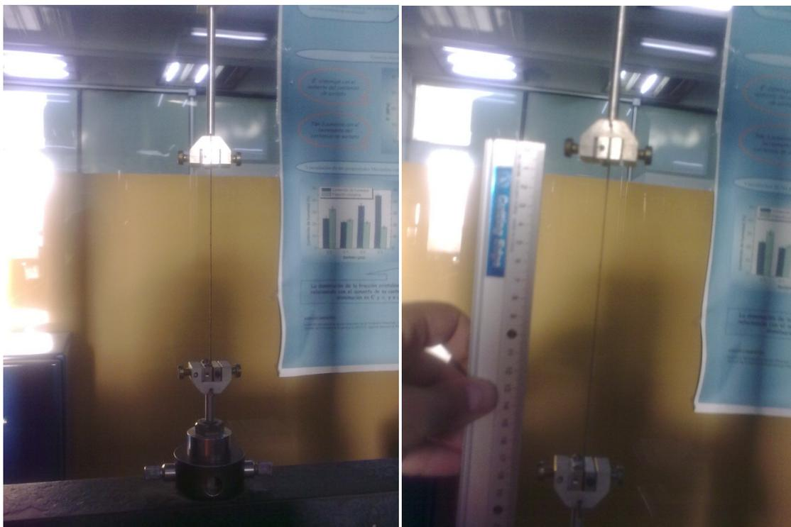
Figura 4.35 – Ensayo de tracción de compuestos funcionalizados con PVP (0,66 %p/p)
