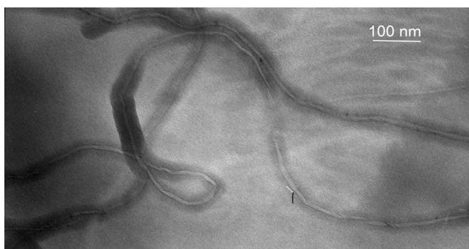
Figura 3.20 – TEM de nanotubos con iniciador (NTC-Cl)
