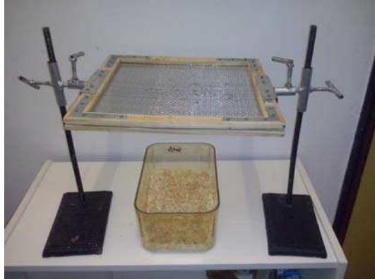
Figura 2: Montaje para la medición de la fuerza de agarre.
