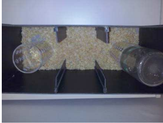
Figura 3: Aparato utilizado para el test de interacción social. Los tubos fueron cubiertos a fin de evitar el escape de los ratones estímulo o la entrada del ratón a testear (no incluido en la foto)
