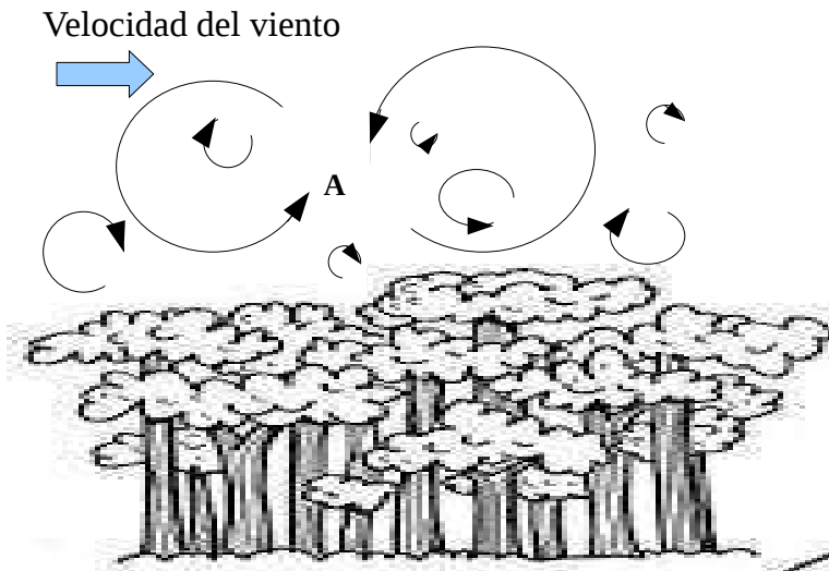
Figura 2.1: Esquema del método de covarianza de remolinos. Los remolinos turbulentos producen movimientos ascendentes y descendentes de distintas parcelas de aire, cada una con una dada concentración de gas, temperatura, humedad y presión, a distintos tiempos. La covarianza entre la velocidad vertical del viento nos permite calcular el flujo de una dada magnitud escalar en el punto A. El coeficiente de difusión vertical puede calcularse a partir de dicho flujo.
