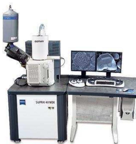
**Figura III.7.** Microscopio electrónico de barrido Zeiss Supra 40.
