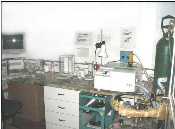
**Figura III.3.** Fotografía del equipo de calorimetría diferencial de barrido.
