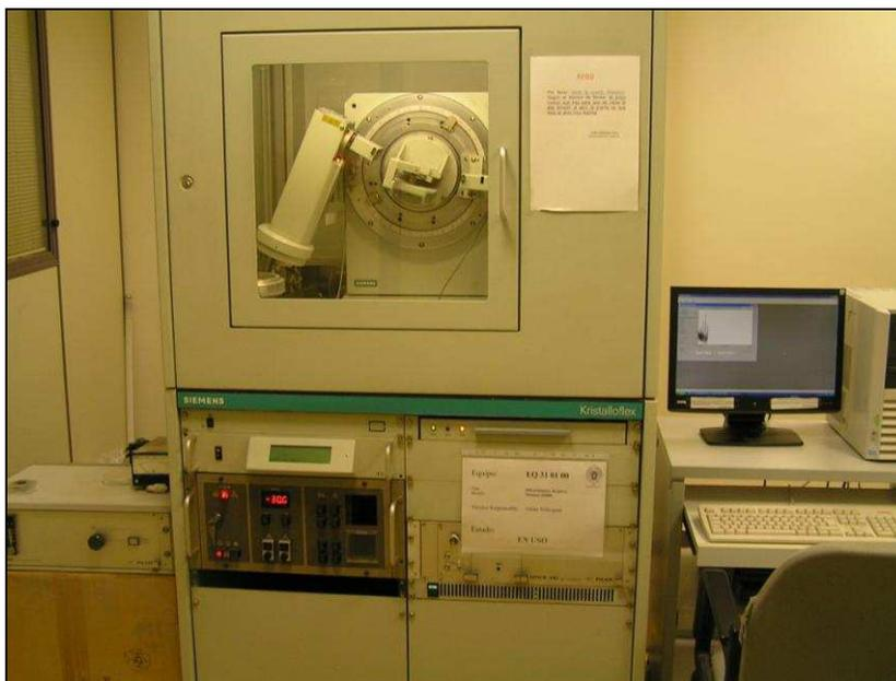
**Figura III.8.** Difractómetro de rayos X Siemens D5000.
