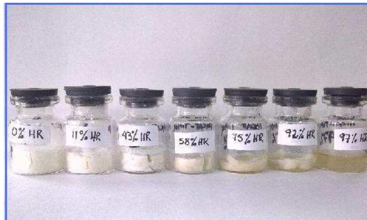
**Figura IV.26.** Fotografía de la matriz timol-HiCap 100 liofilizada y equilibrada a 25°C y a diferentes HR.
