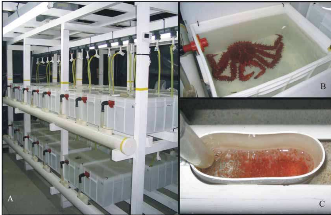
Figura 2.4.- A) Contenedores plásticos dispuestos en el sistema de recirculación de agua salada. B) Detalle del interior de un contenedor en cuyo interior se observa una hembra de L. santolla . C) Filtro colector de larvas en el cual desemboca el rebalse de cada contenedor.
