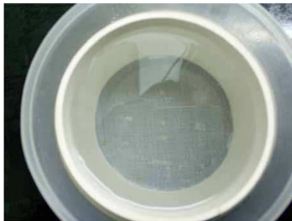
Figura 3.1.- Recipiente de experimentación. Vista superior del tubo de pvc enmallado, inmerso en recipiente contenedor con agua de mar.
