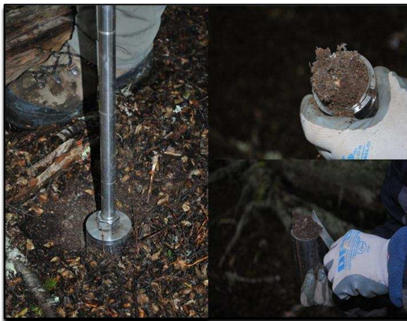
Figura 3.1. Barreno para medir densidad aparente del suelo, y toma de la muestra en un cilindro de volumen conocido.
