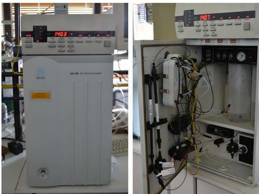
Figura 1.3: Equipo de cromatografía iónica Dionex DRX-100, con columna AG4-AS4 utilizado para la determinación de PMG en los medios de ensayo.
