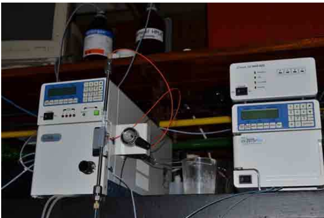
Figura 3.3: Equipo HPLC Jasco con columna C18 fase reversa, utilizado en la determinación de fosfocreatina, creatina, AMP, ADP y ATP en tejidos de O. bonariensis .
