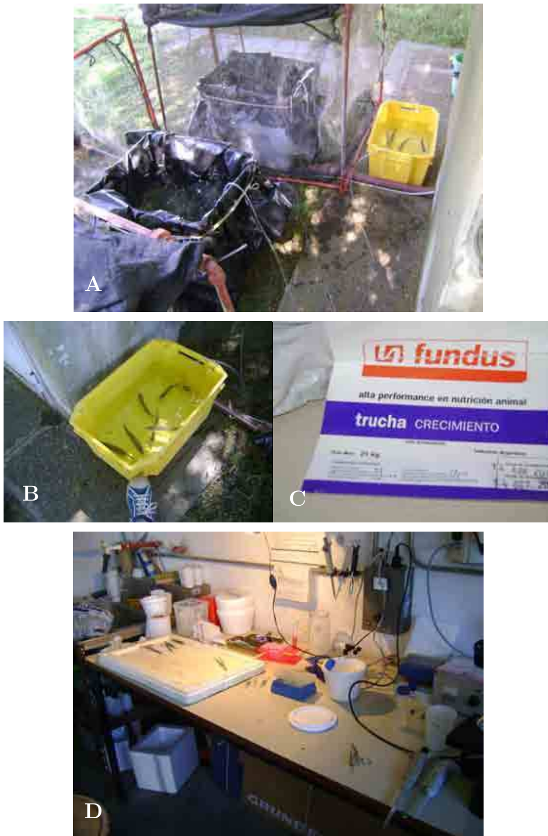
Figura 3.7: Ensayo de exposición crónica de O. bonariensis a un formulado de glifosato. A: Disposición de tanques de 150 L, al momento de inicio de la exposición. B: Grupo de peces retirados de un tanque para adicionar el herbicida. C: Alimento utilizado. D: Laboratorio donde se realiza la disección al finalizar el ensayo.
