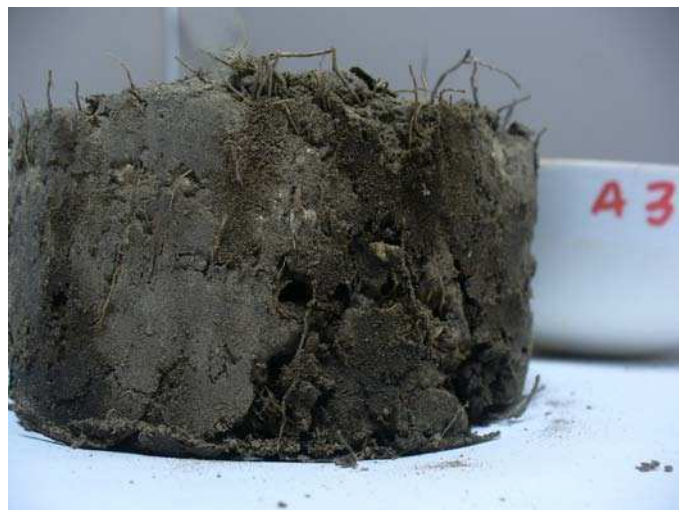
Fig. 5.13. Imagen de una muestra sin disturbar del horizonte A, luego de finalizado el ensayo de laboratorio, en la que se puede observar la estructura y las abundantes raíces de la vegetación.
