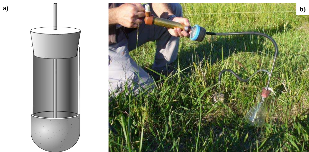
Fig. 3.3. a) Esquema de las cápsulas utilizadas para la extracción de las muestras y b) muestreo de campo con una bomba de extracción manual.
