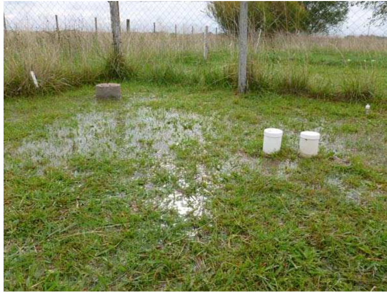
Fig. 2.15. Anegamiento superficial producido en la parcela experimental al superarse la capacidad de infiltración luego de intensas precipitaciones durante agosto de 2012.
