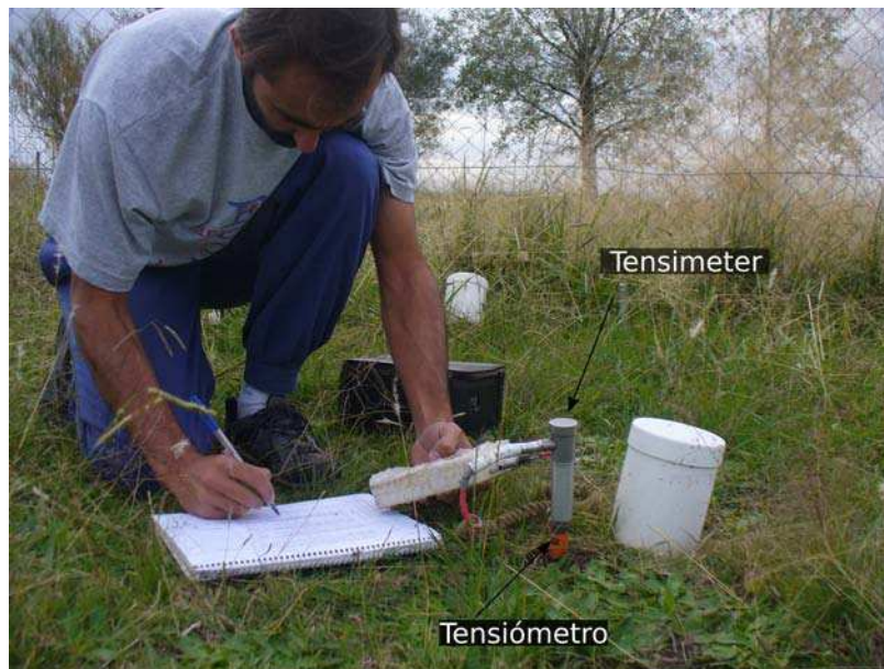
Fig. 2.5. Medición del potencial hidráulico total mediante el uso de tensiómetros y tensimeter .
