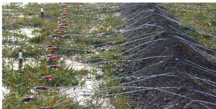
Fig. 5.10. Detalle de los electrodos utilizados para las mediciones de resistividad. La separación entre ellos es de 20 cm. Se observan dos tensiómetros de 15 cm de profundidad.
